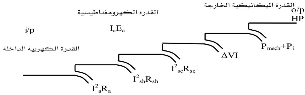
شكل ٣ - ٢٠ مخطط انسياب القدرة لمحركات التيار المستمر
